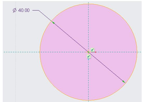
13. Создаем деталь elka3, выполняем плоскую деталь толщиной 3 мм в виде круга диаметром 40 мм в соответствии с рисунком.
