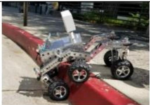
Подвеска «Rocker bogie». Машина с полно приводной (на 6 моторов) гибкой подвеской, хорошей проходимости, но с риском застревания в расщелинах. Используется для построения планетоходов (марсоходов). Электропривод.
