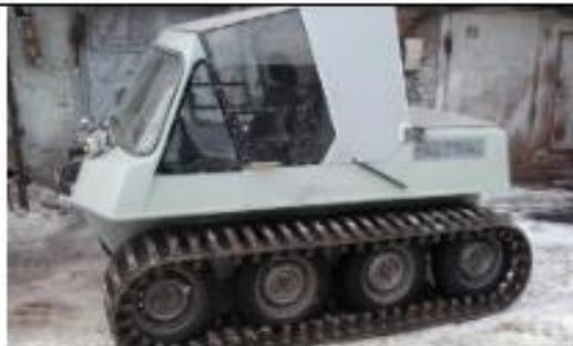
Машина с гусеничным приводом. Обладает хорошей маневренностью, способна двигаться по сложно-пересеченной местности, имеет хорошую проходимость по сравнению с колесными моделями на рыхлых поверхностях за счет хорошего сцепления. Имеет высокую проходимость препятствий соразмерных и больших диаметра колеса. Менее устойчивая, чем 6-ти колесная подвеска. Двигатель внутреннего сгорания.
