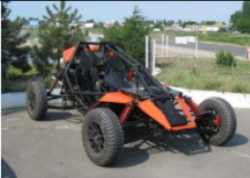
Багги- гоночная спортивная машина, высокая скорость, но относительно низкая проходимость и маневренность. Имеет рессоры, способна преодолевать препятствия, но с малым относительно собственных размеров перепадом высот. Имеет небольшую грузоподъемность и малый относительный вес. Ограниченность маневра за счет использования рулевого механизма. Двигатель внутреннего сгорания.
