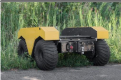
Машина с полно приводной (на 4 мотора) жесткой подвеской, большой мощности. Не предназначена для перевозки пассажиров и больших грузов, но способна за счет мощности привода проходить сложные препятствия. Обладает низкой устойчивостью и стабильностью при преодолении сложных рельефов, по высокой прочностью корпуса и надежностью. Обладает возможностью выполнить танковый разворот на месте. Электропривод.
