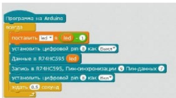
**Рис. 1. Пример кода программ на Scratch-подобном языке программирования роботов**
