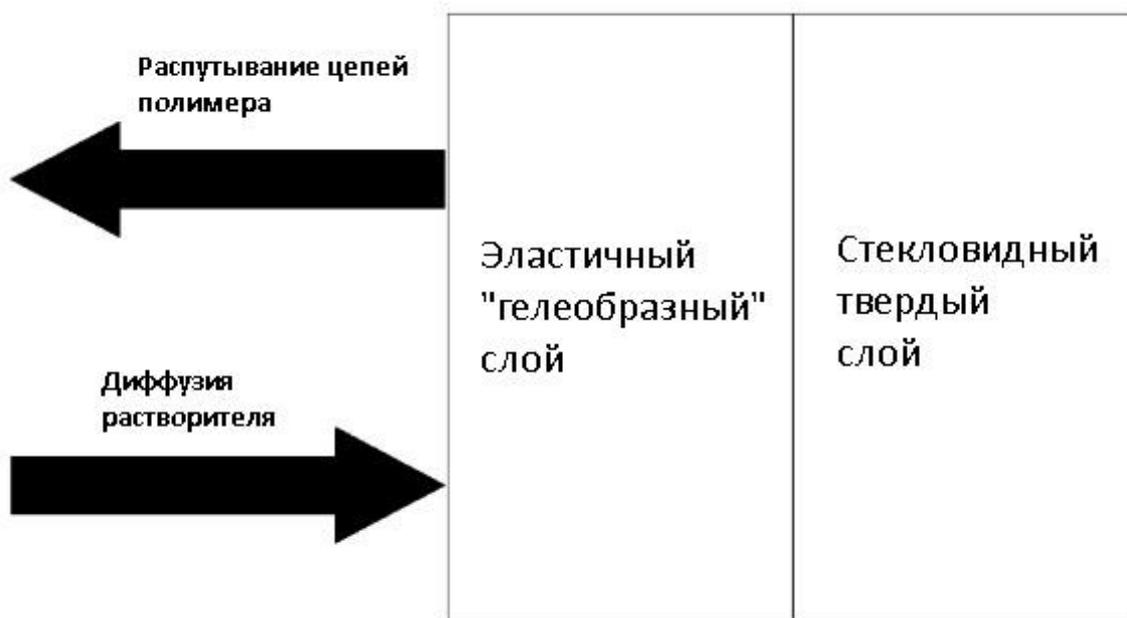
При контакте с растворителем, последний заполняет эти каналы и отверстия и запускает процесс диффузии (новые каналы при этом не образуются). Схематически такой поверхностный слой растворяющегося полимера выглядит так (грубо говоря, «клей» = гелеобразная масса, то, что находится посередине между твердым полимером и жидким растворителем):
