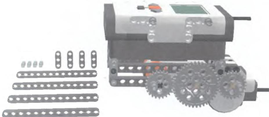
Рис. 3.41. Со стороны мотора штифты вставляются в противоположные отверстия соседних шестеренок и на NXT.
