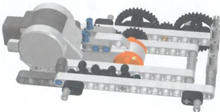
Рис. 3.57. Передняя часть крепится трехмодульными штифтами на петлю
