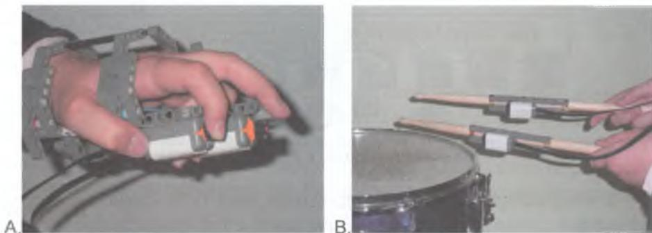
Рис. 8.74. Конструкции для управления роботом-барабанщиком: А – на датчиках касания, В – на гироскопических датчиках.
