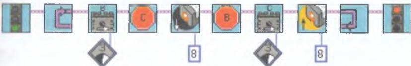
Рис. 8.32. Алгоритм движения по линии с одним датчиком освещенности: понижена скорость, увеличена разница между черным и белым.
