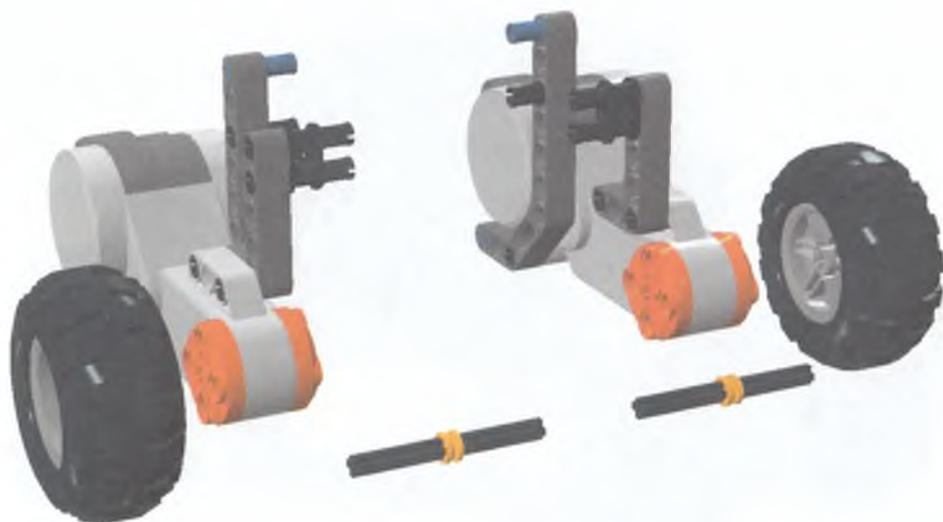
**Рис. 3.73.** Колеса устанавливаются на 6-модульные оси, втулки предохраняют от нежелательного трения шин о корпуса двигателей.
