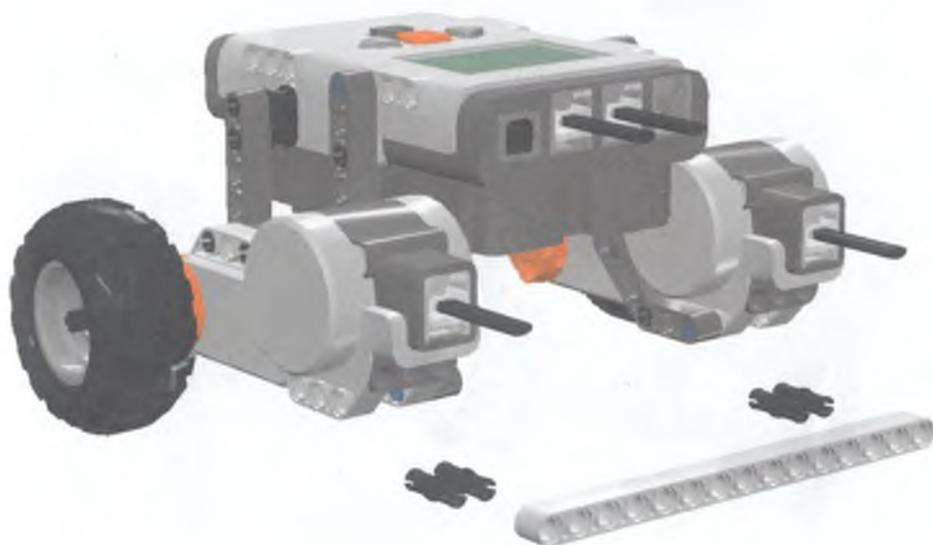
**Рис. 3.74.** Две половинки соединяются контроллером NXT и 15-модульной балкой, которая крепится к каждому мотору на 2 штифта.
