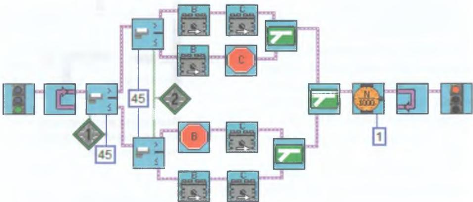
Рис. 7.7. Алгоритм движения вдоль черной линии с двумя датчиками на релейном регуляторе.
