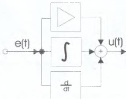
Рис. 7.35. Схема ПИД-регулятора.
