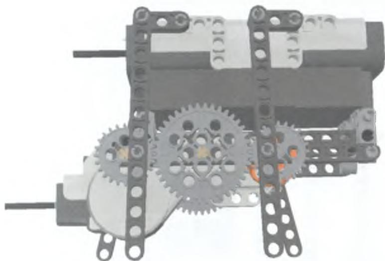
Рис. 3.44. С другой стороны конечности встают в противофазе.
