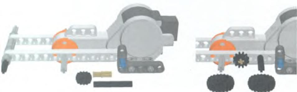
Рис. 3.49. Шестерня 12-зубая ставится на бежевый штифт с поворотом на ползубца.
