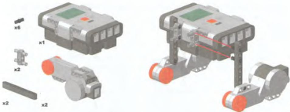
Рис. 3.89. Крепление моторов и NXT [4].
