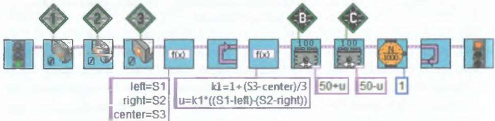
Рис. 7.34. Движение по линии на пропорциональном регуляторе с плавающим коэффициентом.
