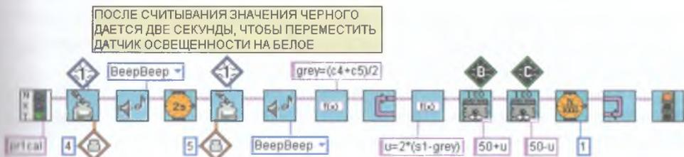
Рис. 8.37. Алгоритм движения по линии с одним датчиком освещенности на пропорциональном регуляторе с расчетом значения серого.
