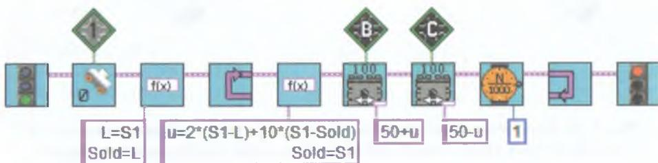
Рис. 7.26. Алгоритм движения вдоль стенки, основанный на ПД-регуляторе.
