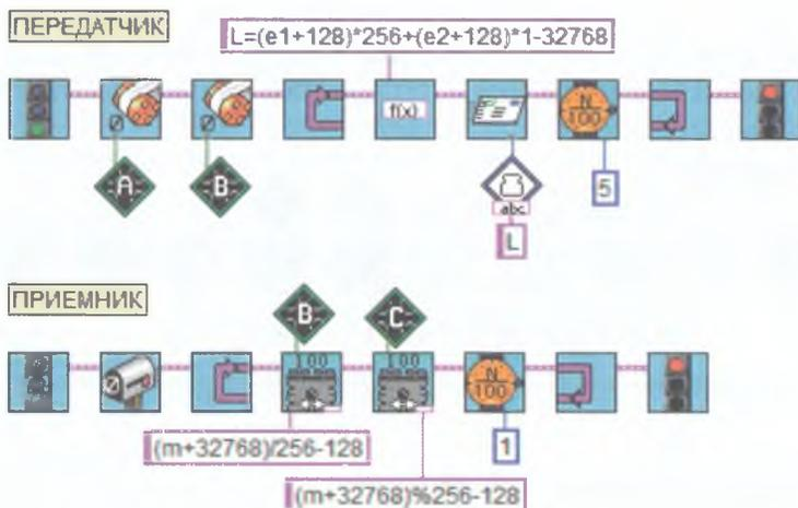
Рис. 8.95. Управление моторами через Bluetooth с помощью самодельного джойстика (конструкция на рис. 8.91 А).
