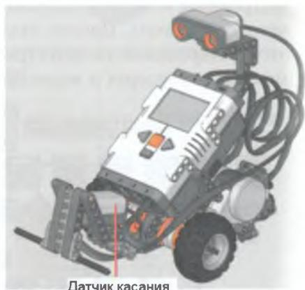
Рис. 8.55. Бампер с датчиком касания для маленького исследователя.
