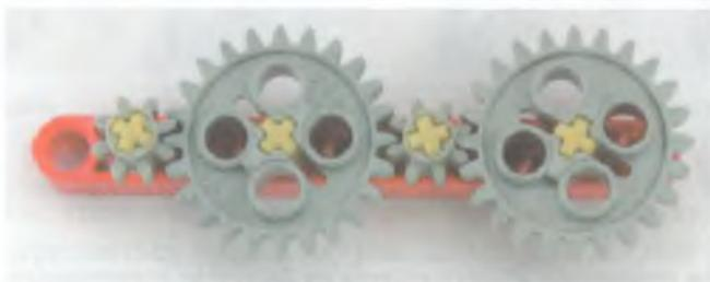
Рис. 2.8. Две промежуточные шестерни – паразитные [3].
