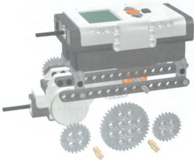
Наиболее сложная задача – выравнивание шестеренок. Все 4 основные шестерни (24 зуба) должны быть расположены так, чтобы пары отверстий в них были строго параллельны друг другу (рис. 3.38). Расположение 40-зубых центральных шестеренок не играет роли.
