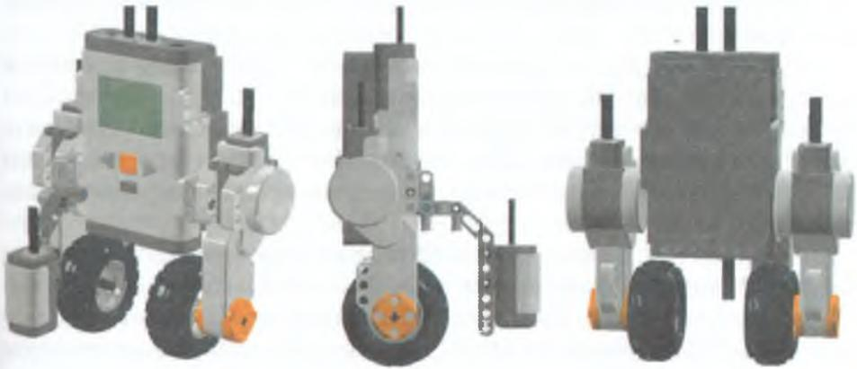
Рис. 7.36. Балансирующий робот-сигвей.
