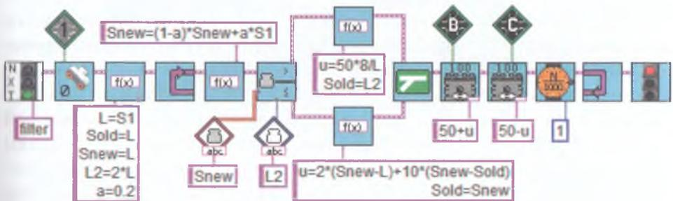
Рис. 8.66. Алгоритм движения вдоль стенки с фильтрацией данных.
