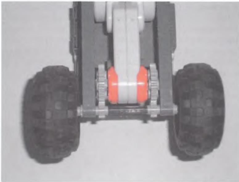
Рис. 3.26. Повышающая передача 1:3 для скоростной тележки.
