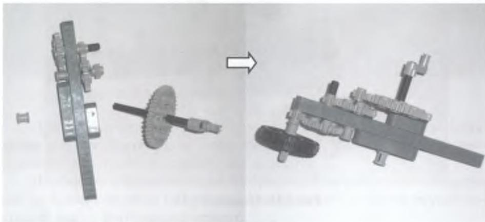
**Рис. 2.18.** Защита от холостого прокручивания шестеренок.
