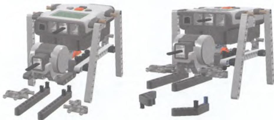
Рис. 3.62. Балки 11-модульные на черных штифтах крепятся под двигателем.
