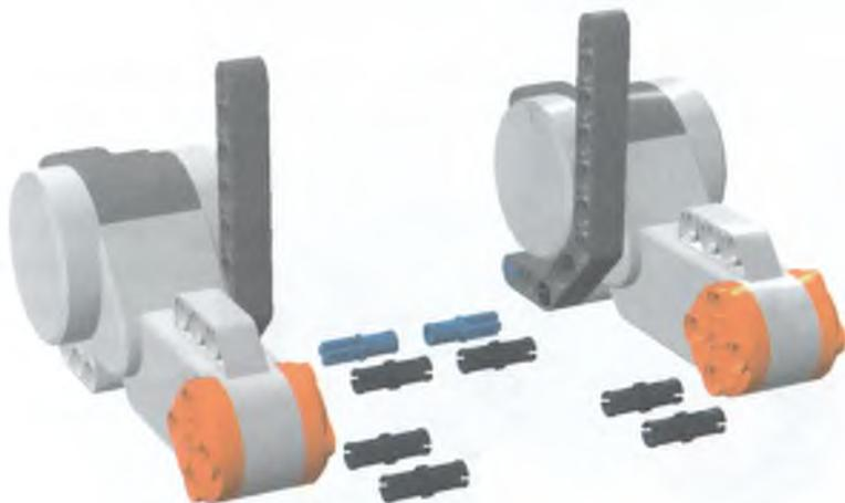
Рис. 3.71. В зависимости от расположения балок может быть смещен центр тяжести тележки.
