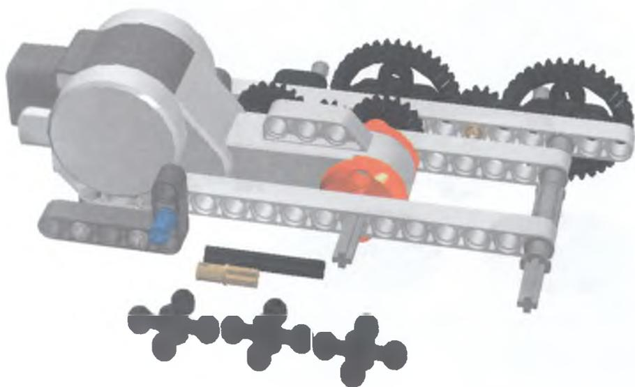
Рис. 3.54. На левой стороне используем 4-зубые шестерни.
