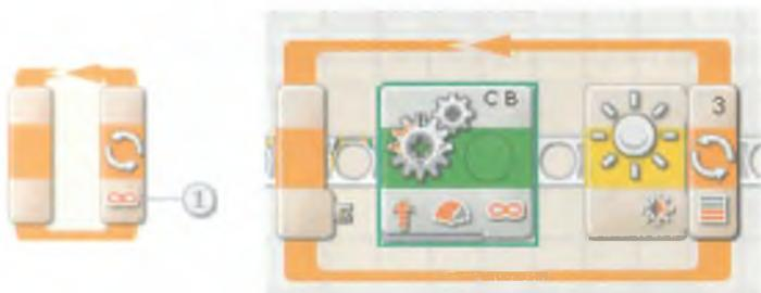
Рис. 4.8. Пиктограмма бесконечного цикла (слева), цикл по датчику освещенности (справа).
