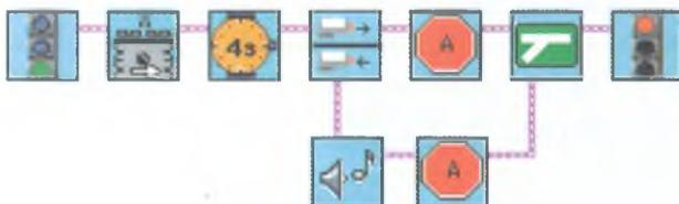
Рис. 5.13. Пример ветвления по состоянию датчика касания.
