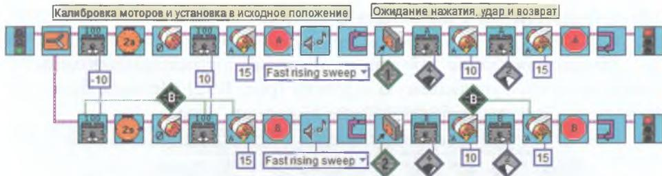
Рис. 8.73. Алгоритм управления двумя палочками с помощью двух датчиков.
