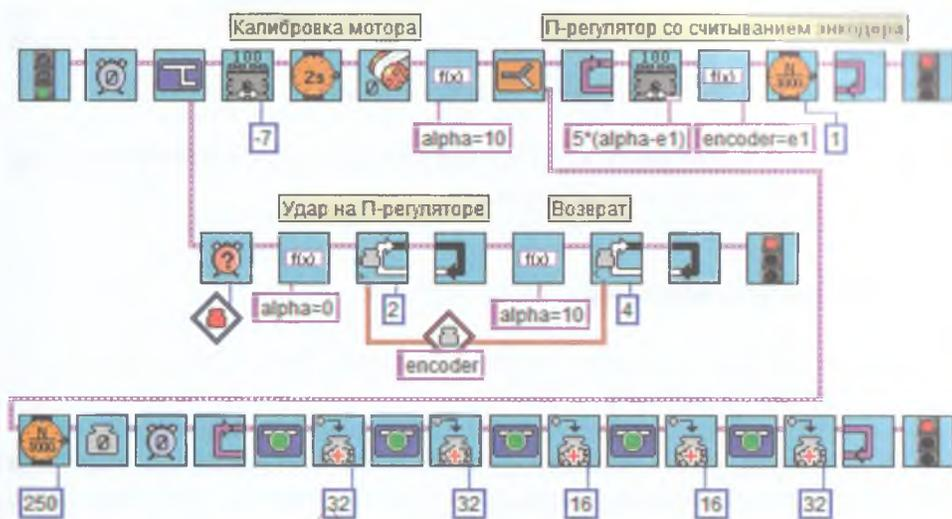
Рис. 8.78. Управление сбалансированной барабанной палочкой с помощью П-регулятора.
