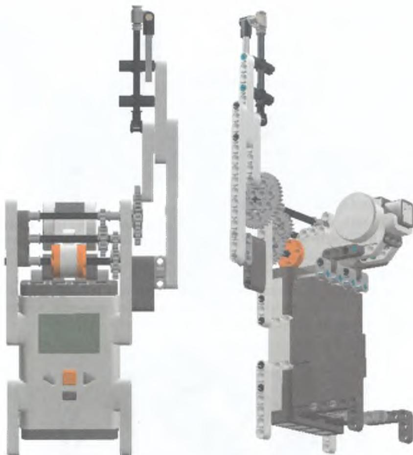
**Рис. 3.66. Модель маятника Капицы, выполненная в Lego Digital Designer из деталей Mindstorms. Передача 1:9.**
