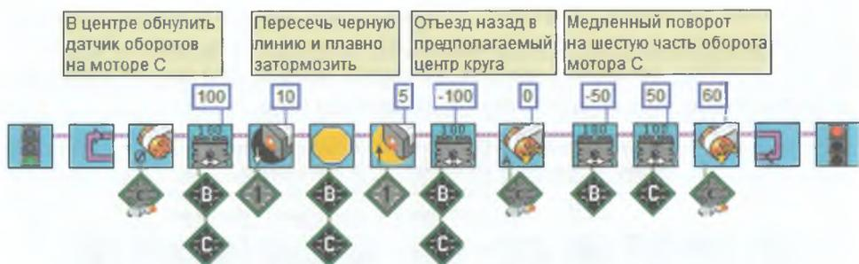
Рис. 8.22. Алгоритм «Танец в круге» с датчиками оборотов.
