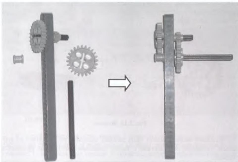
Рис. 2.15. Двухступенчатая передача 1:9 (с учетом малой шестерни волчка).
