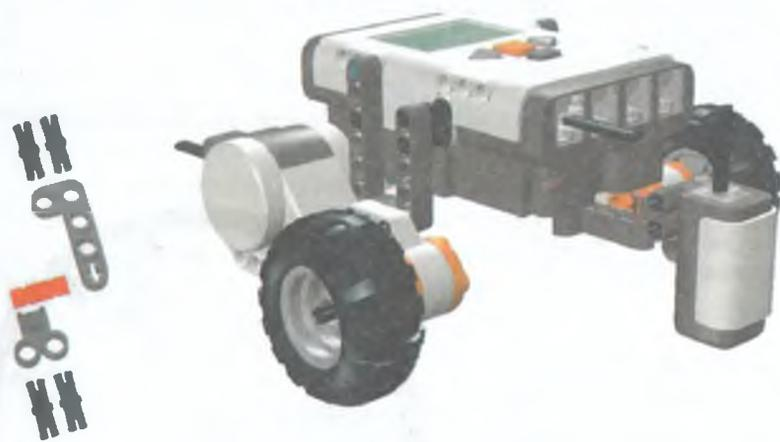
Рис. 8.13. Трехколесная тележка с креплением датчика освещенности.
