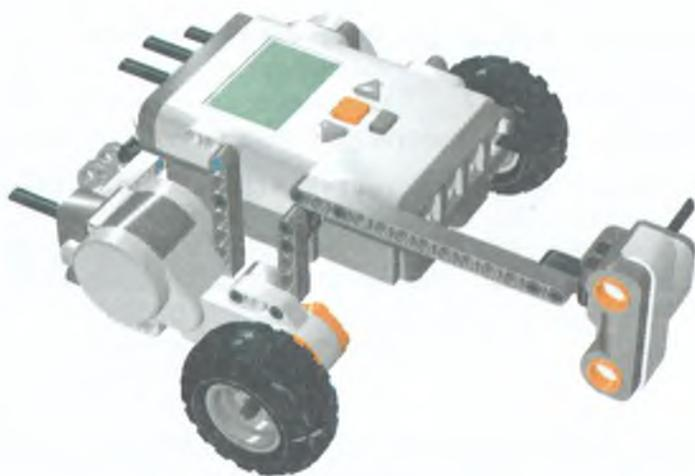
Рис. 7.29. Оптимальный вариант – вертикальное расположение датчика.
