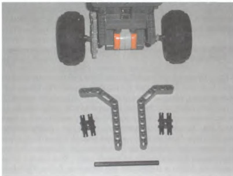
**Рис. 3.30. Изогнутые балки – основа для бампера.**
