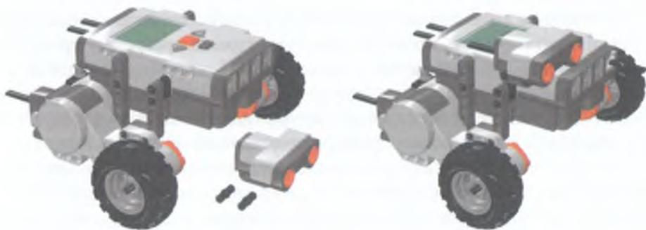
Рис. 8.50. Датчик, прикрепленный к корпусу тележки, должен смотреть строго горизонтально.
