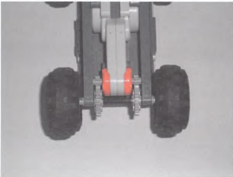
Рис. 3.27. Понижающая передача 3:1 для робота-тягача.
