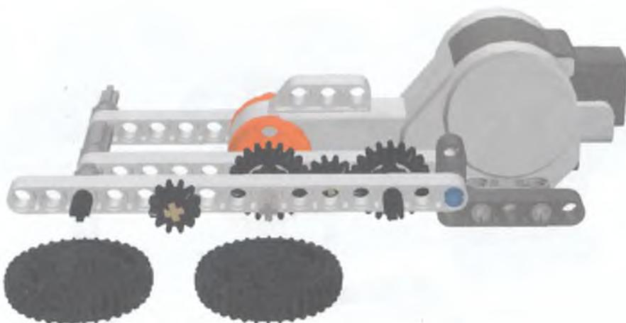
Рис. 3.51. Вторая 12-зубая шестерня тоже поворачивается на ползубца для стыковки с 36-зубыми.
