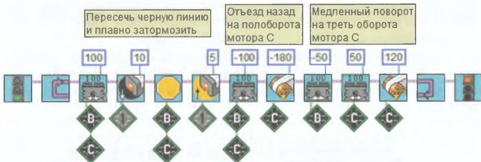
Рис. 8.20. Алгоритм «Танец в круге» с движением по датчикам оборотов.
