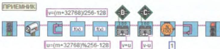
Рис. 8.96. Прием управляющих сигналов скорости и поворота с одноручного джойстика (конструкция на рис. 8.86 В)
