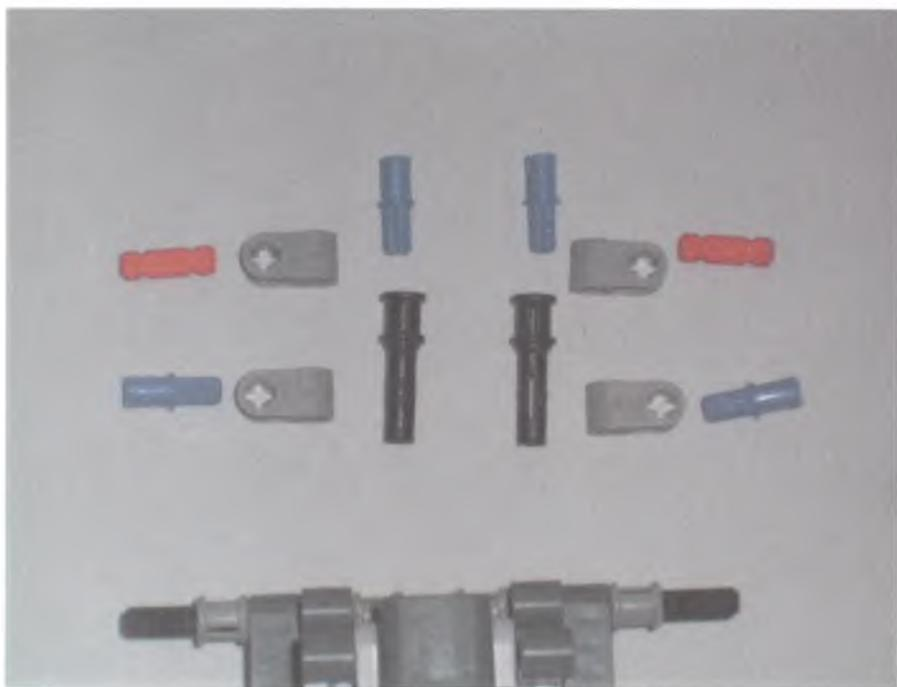
Рис. 3.18. Набор шрифтов, мини-осей и фиксаторов для заднего крепления NXT.
