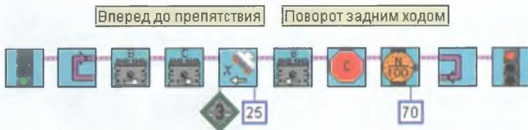
Рис. 8.52. Алгоритм путешествия по комнате с поворотом задним ходом.
