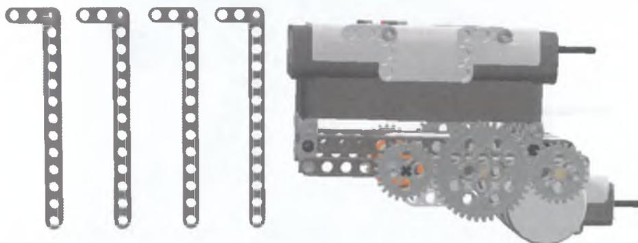
Рис. 3.42. Ноги робота должны быть одинаковыми, но их длину можно менять.
