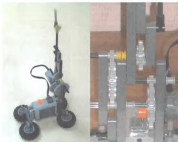
Рис. 3.65. Маятник Капицы из Lego Technic с передачей 1:25.
