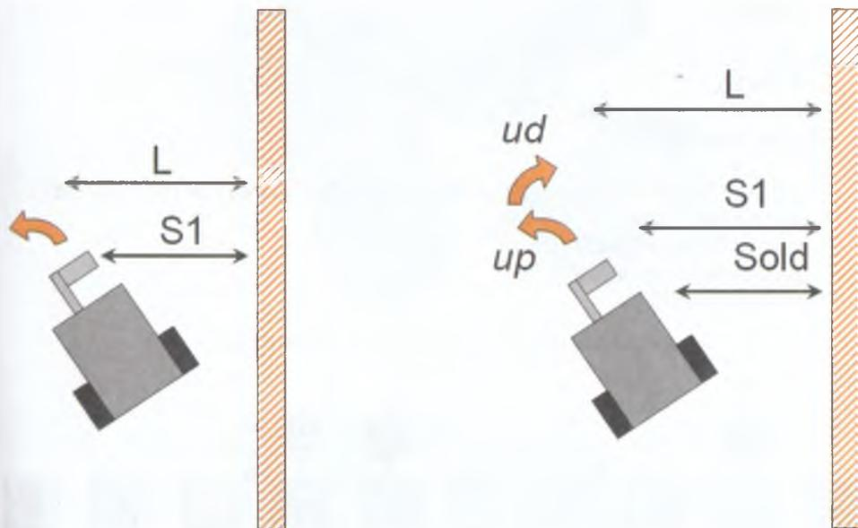
Рис. 7.25. Проблема пропорционального регулятора – потеря контакта со стенкой (слева). Необходима дифференциальная составляющая (справа).
