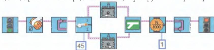
Рис. 7.2. Релейное управление одним мотором.
