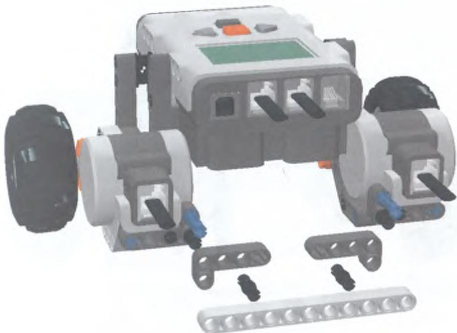
Рис. 3.79. Еще пара уголков, к которым крепится задняя балка.
