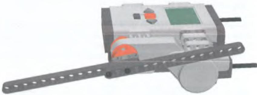
**Рис. 8.79.** Сбалансировать палочку дополнительной балкой.
