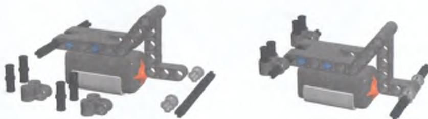
Рис. 8.58. Нажатие осуществляется «пяточкой» изогнутой балки 3x5.
