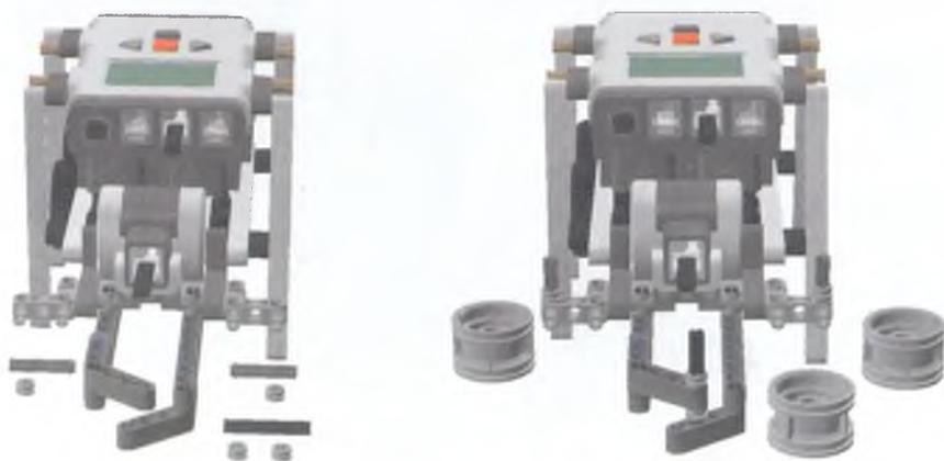
Рис. 3.63. Три модульных штифа для крепления роликовых дисков
