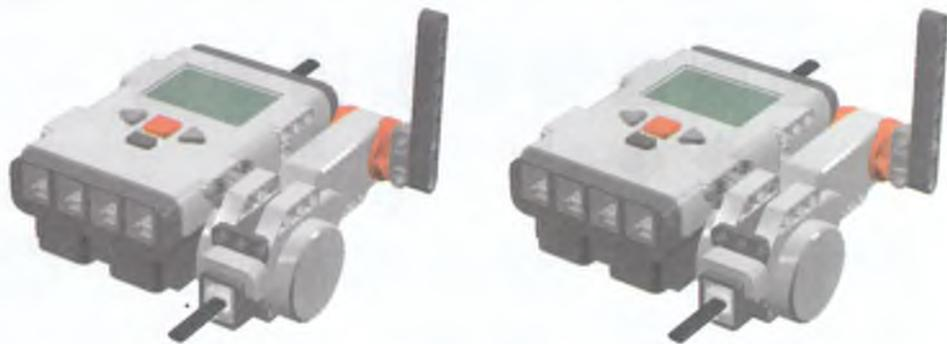
Рис. 8.87. Мотор приемника повторяет движения мотора передатчика.
