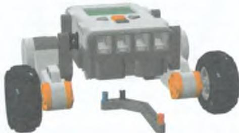
Рис. 8.28. Крепление датчика освещенности к трехколесной тележке.
