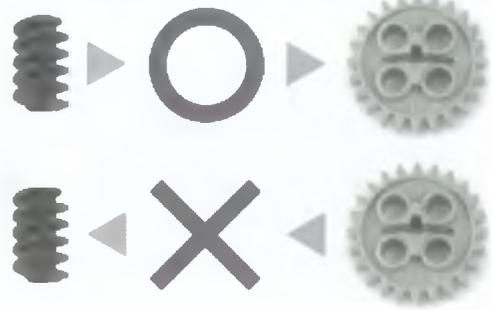
**Рис. 2.11.** Червячная передача работает только в одну сторону: от червяка к шестерне [3].
