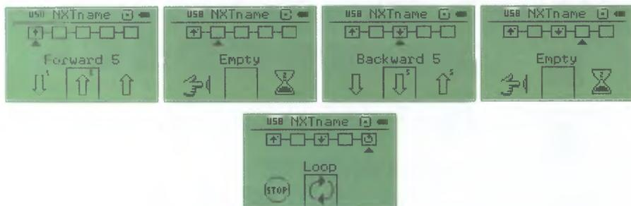
Рис. 3.85. Движение вперед-назад с помощью высокоуровневых команд.
