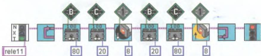
Рис. 8.33. Алгоритм движения по линии с одним датчиком освещенности: улучшено управление моторами.
