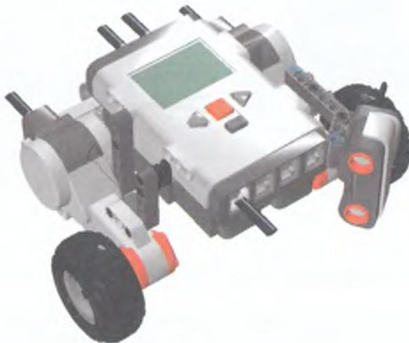
Рис. 8.62. Увеличенное за счет корпуса робота расстояние до стены способствует расширению области обзора.
