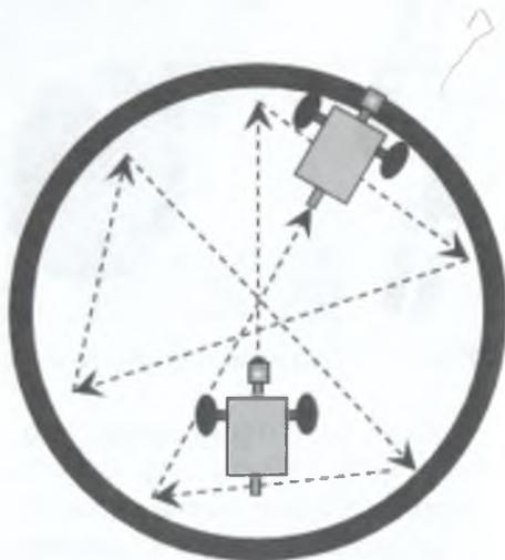
Рис. 8.15. Траектория движения робота в круге.
