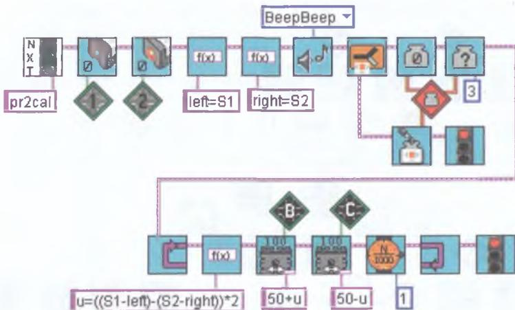
Рис. 8.45. Алгоритм движения по линии с использованием П-регулятора. Ожидание повторного нажатия оранжевой кнопки после сигнала.
