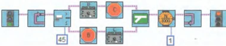
Рис. 7.5. Алгоритм движения вдоль границы черного и белого на релейном регуляторе.
