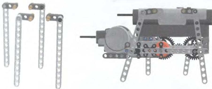
Рис. 3.60. Конечности крепятся на 6 отверстие снизу, а верхние суставы на второе и четвертое отверстия на борту NXT.
