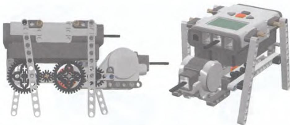
Рис. 3.61. Перед у робота получился со стороны мотора. Запуск – мотор назад.
