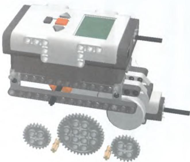
Рис. 3.36. На ведущие оси насаживаются 24-зубые шестерни.
