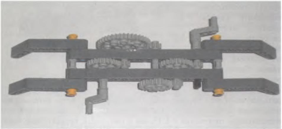
**Рис. 2.12.** Механическая передача с передаточным числом 135.
