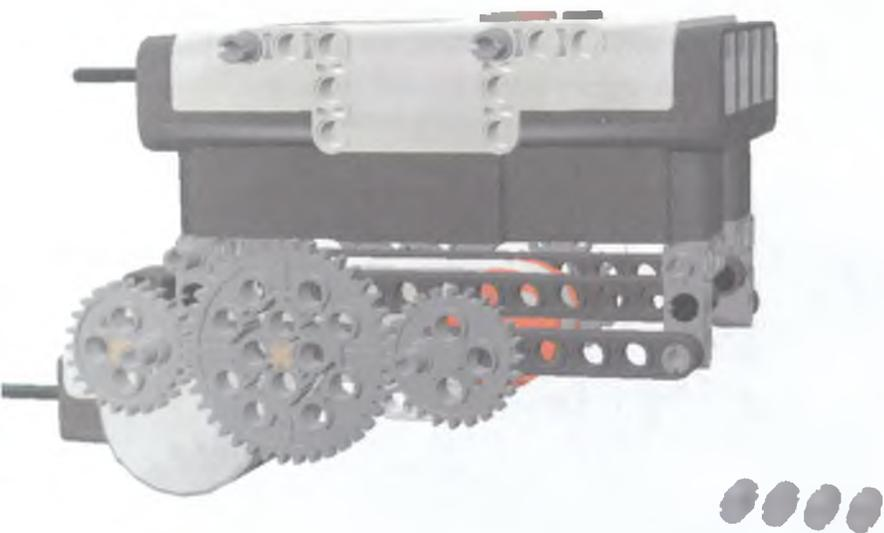
Рис. 3.40. Гладкие серые штифты вставляются в противоположные отверстия соседних шестеренок и на NXT.
