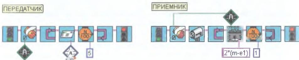
Рис. 8.86. Передача значения энкодера и управление положением удаленного мотора с помощью П-регулятора.
