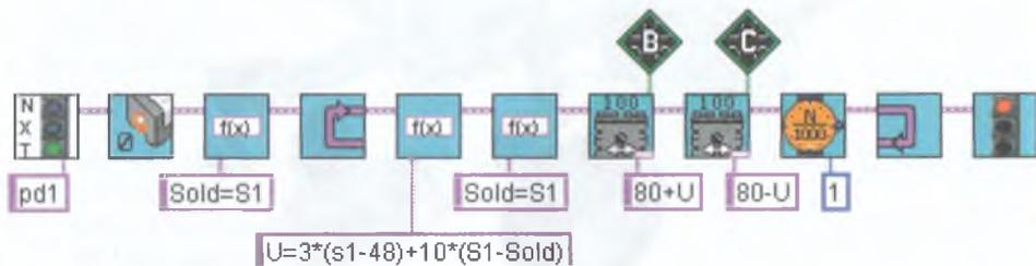
Рис. 7.30. Движение по линии на ПД-регуляторе с одним датчиком света.
