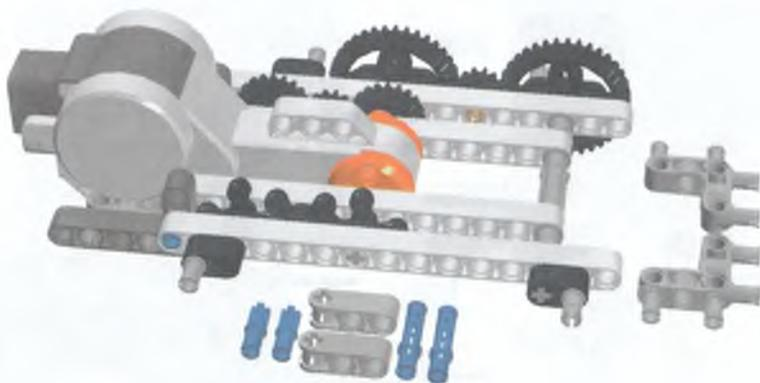
Рис. 3.56. После установки черных двухмодульных балок с двумя серыми штифтами переходим к креплению для контроллера.
