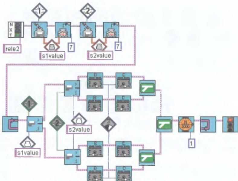
Рис. 8.43. Алгоритм движения по линии на релейном регуляторе с калибровкой двух датчиков освещенности на белом.
