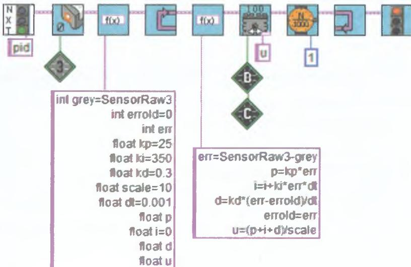
Рис. 7.37. Алгоритм балансирующего робота основан на ПИД-регуляторе.
