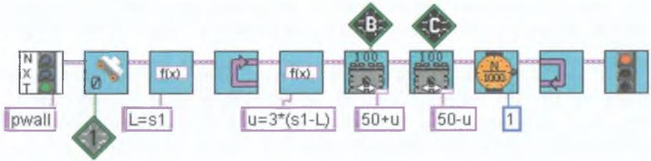
Рис. 7.24. Алгоритм движения вдоль стенки на основе пропорционального регулятора.
