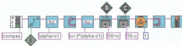
Рис. 7.13. Алгоритм движения по азимуту с использованием П-регулятора.
