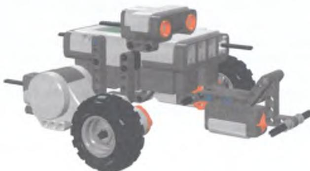
Рис. 8.59. Конструкция с датчиком крепится непосредственно к NXT.
