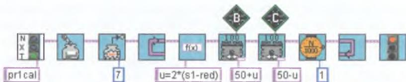
Рис. 8.35. Алгоритм движения по линии с одним датчиком освещенности на пропорциональном регуляторе с предварительной калибровкой (определением значения серого).
