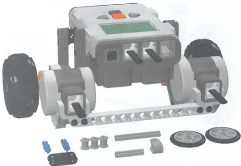
Рис. 3.75. Элементы подвижного колеса. Длины осей – 3 и 5 модулей.
