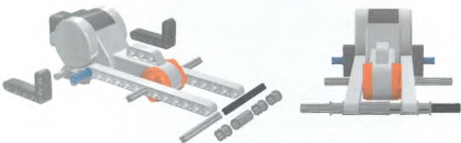
Рис. 3.48. Несущие 13-модульные балки крепятся в трех точках.
