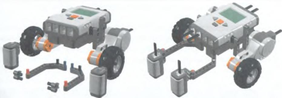
Рис. 8.42. Крепление двух датчиков на изогнутых балках.
