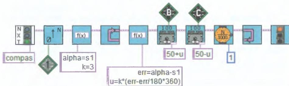
Рис. 7.15. Алгоритм движения по компасу с ограничением диапазона отклонения.
