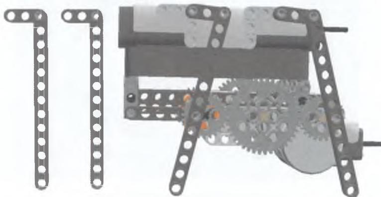
Рис. 3.43. Установка конечностей.
