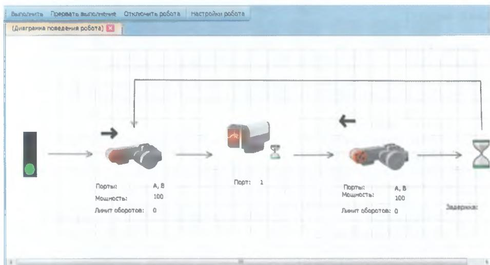
Рис. 8.98. Пример исполнения программы в QReal.
