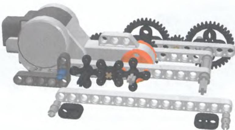
Рис. 3.55. Для стыковки 4-зубых шестеренок следует повернуть центральную.
