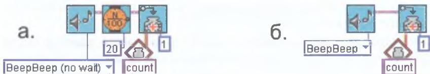
Рис. 8.47. Задержка при увеличении счетчика: а – с помощью блока времени, б – с помощью звукового сигнала.
