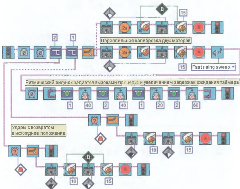
Рис. 8.77. Алгоритм барабанщика с двумя палочками.
