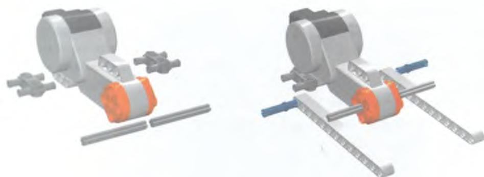
Рис. 3.47. Две пятимодульные оси вставляются в вал двигателя несимметрично: одна выступает на модуль больше.
