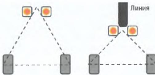
**Рис. 8.41.** Расположение двух датчиков освещенности.
