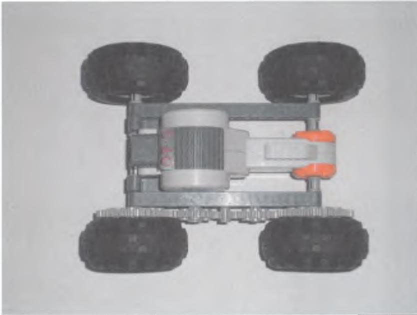
**Рис. 3.13.** При таком расположении колес возникает трение с соседними шестеренками.
