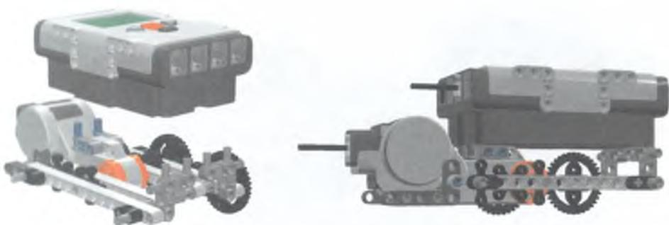
Рис. 3.58. Штифты размещаются на двигателе и несущих балках точно под нижними отверстиями на корпусе NXT.
