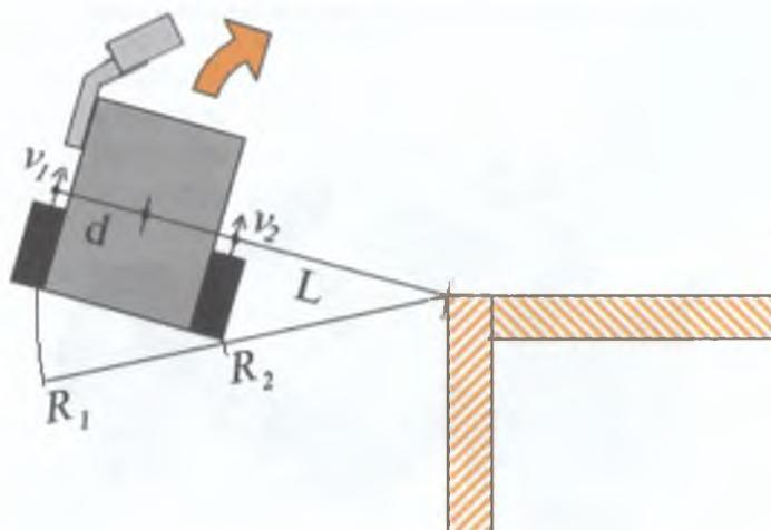
Рис. 8.63. Выполнение поворота при потере контакта со стенкой.
