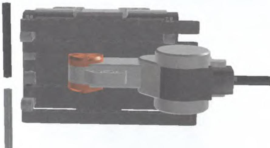
Рис. 3.35. Вид снизу. Ведущие оси будут разной длины: 5 и 6 модулей.
