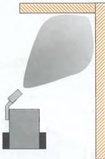
**Рис. 8.60.** Датчик расстояния устанавливается под острым углом к направлению движения.
