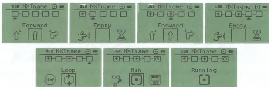
Рис. 3.1. Составление и запуск программы для включения мотора В или С.
