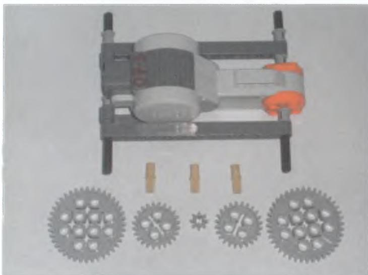
Рис. 3.11. Наиболее эффективное расположение шестеренок для полноприводной тележки.
