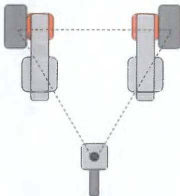
Рис. 3.67. Схема трехколесной тележки с подвижным третьим колесом
