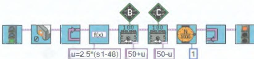
Рис. 7.20. Алгоритм движения вдоль черной линии, основанный на П-регуляторе.
