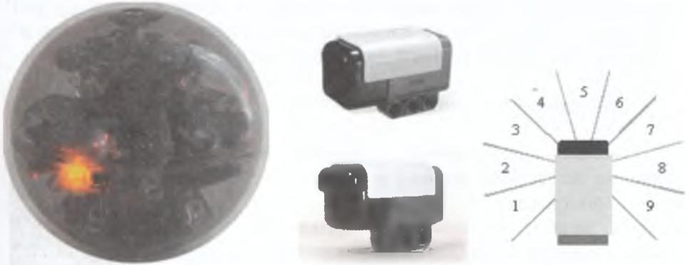
Рис. 7.16. Инфракрасный мяч, компас, инфракрасный поисковик и его секторы обзора.
