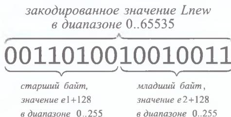
**Рис. 8.94. Битовая структура закодированного сообщения.**
