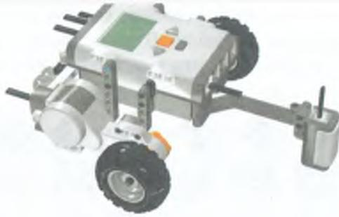
Рис. 8.30. Высота датчика над поверхностью поля – от 5 до 10 мм.
