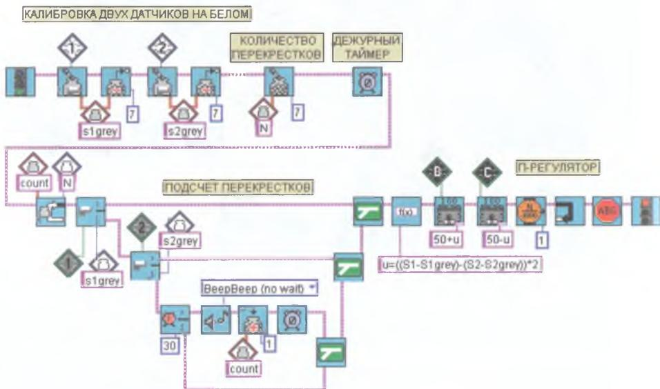
Рис. 8.48. Подсчет перекрестков со звуковым сигналом. На проезд перекрестка выделено 0.3 с.
