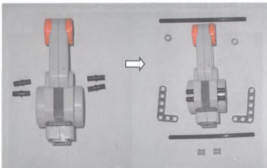
Рис. 3.6. Одномоторная тележка. Первая 12-модульная ось будет ведущей. Другая ось вставляется в угловую балку, второе от угла отверстие.
