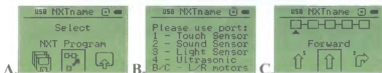
Рис. 3.82. Встроенная среда программирования NXT Program.
