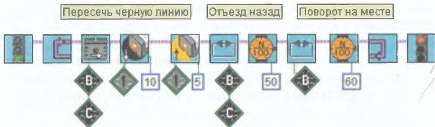
Рис. 8.18. Алгоритм «Танец в круге» с выездом точно за его пределы.
