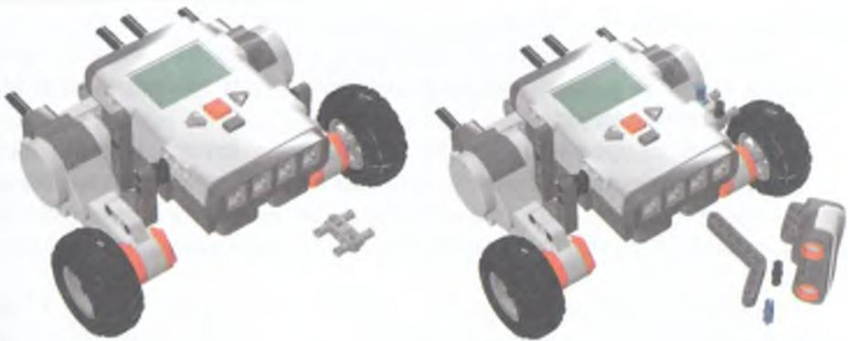
Рис. 8.61. Крепление размещается на левой стороне. Как и в первой конструкции, датчик располагается вертикально.
