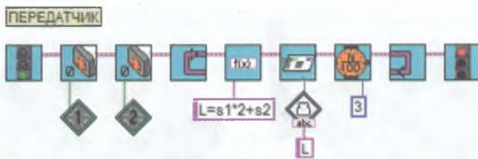
Рис. 8.89. Передача закодированного сигнала с двух датчиков касания.
