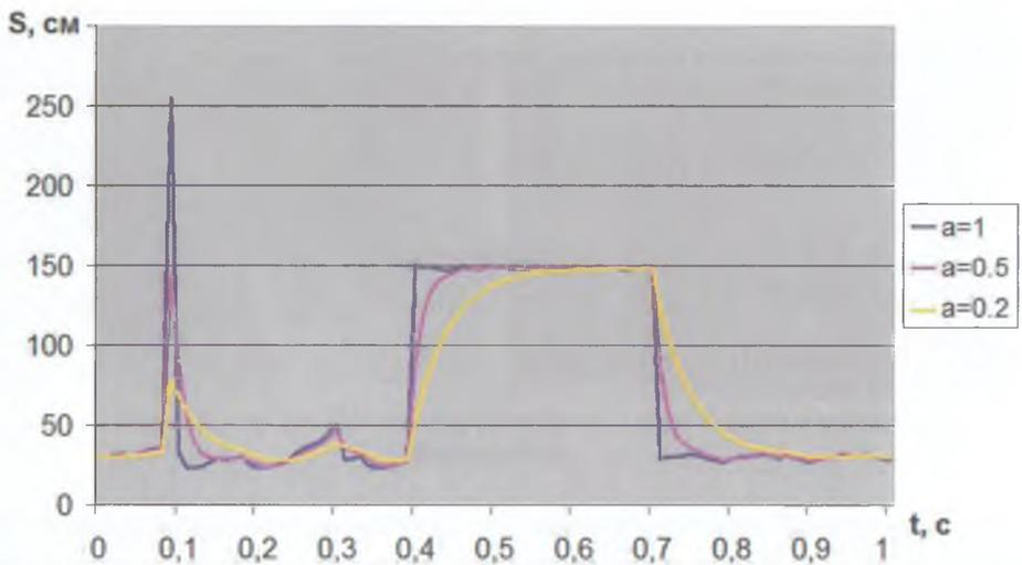
Рис. 8.65. Результаты фильтрации показаний датчика ультразвука с различными коэффициентами.
