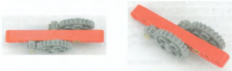
Рис. 2.9. Двухступенчатая передача [3].
