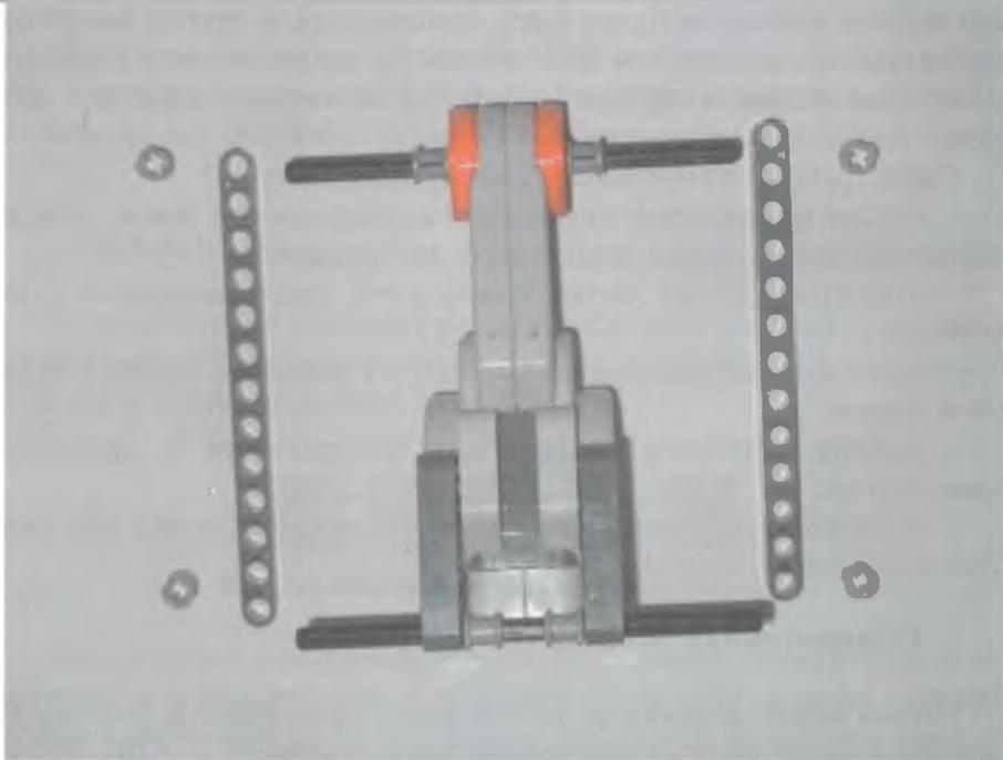
**Рис. 3.7.** Обе оси фиксируются 13-модульными балками, расположенными параллельно корпусу двигателя.
