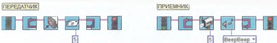
Рис. 8.80. Передача числа 5 по нажатию датчика и ответный звуковой сигнал.
