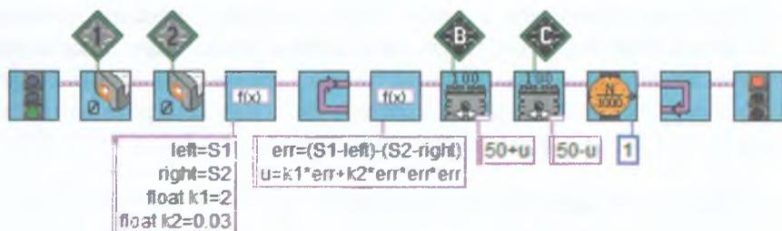
Рис. 7.32. Пропорционально-кубический регулятор для движения по линии с двумя датчиками.
