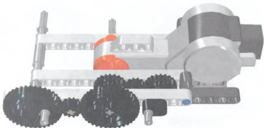
Рис. 3.53. Установка гладких серых штифтов для крепления конечностей завершает правую сторону.
