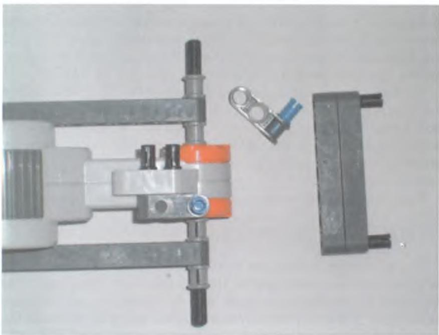
Рис. 3.15. Трехмодульные штифты скрепляют сразу три детали.
