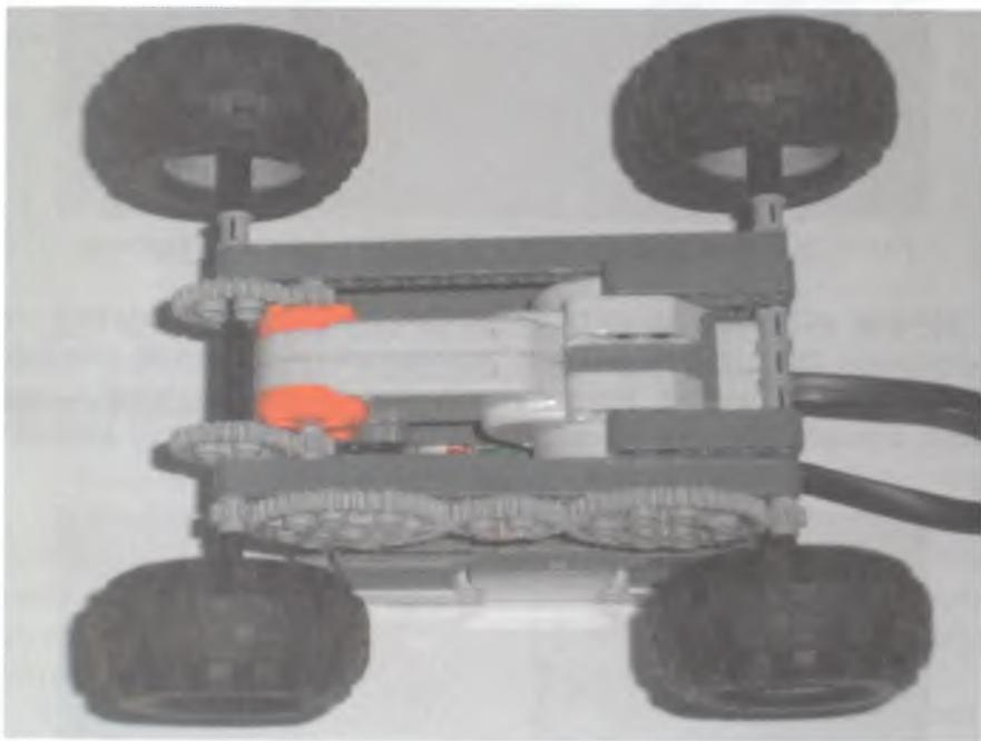
**Рис. 3.28.** Полный привод для робота-тягача.
