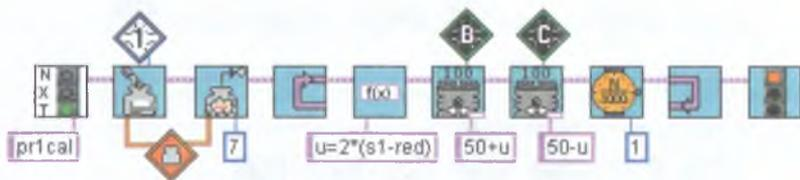
Рис. 8.36. Алгоритм движения по линии с одним датчиком освещенности на пропорциональном регуляторе – с модификаторами.
