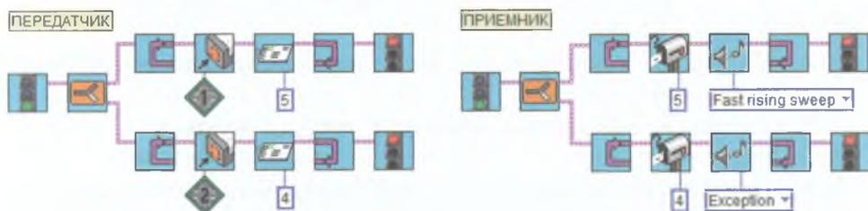
Рис. 8.81. Передача чисел 4 или 5 по нажатию соответствующего датчика и ответные звуковые сигналы.
