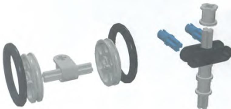
Рис. 3.76. Сборка заднего подвижного колеса. Оси должны вращаться свободно.
