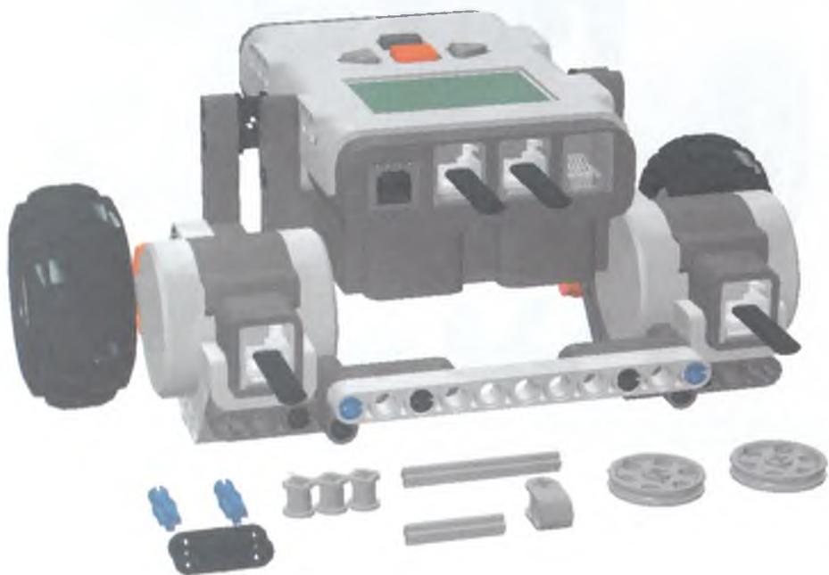
Рис. 3.80. Шины на диски подвижного колеса можно не надевать.
