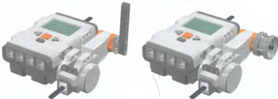
Рис. 8.83. Приемник вращает колесо со скоростью, заданной на передатчике поворотом балки.
