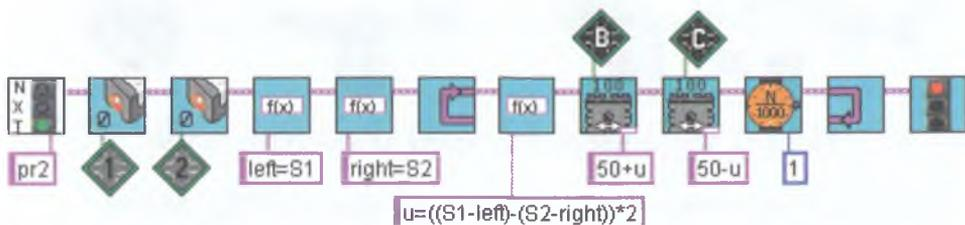
Рис. 8.44. Алгоритм движения по линии на П-регуляторе с калибровкой двух датчиков освещенности.
