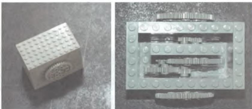
Рис. 2.20. Осевой редуктор с передаточным числом 15 и обратным направлением вращения.
