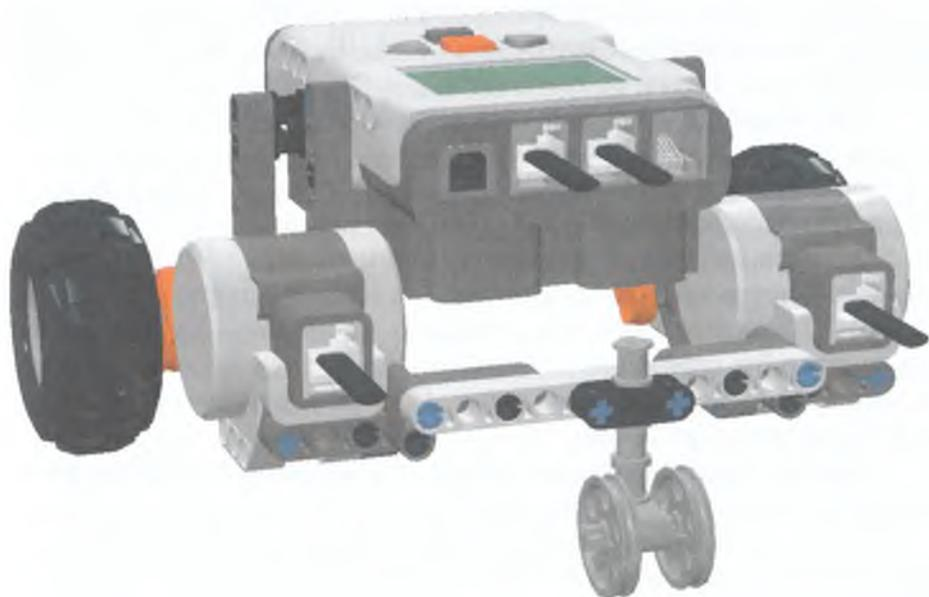
Рис. 3.81. Корпус такой тележки расположен горизонтально и колесико вращается вокруг вертикальной оси свободно.
