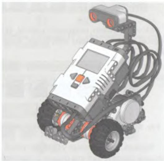
Рис. 8.49. Маленький исследователь из набора 9797 с ультразвуковым датчиком.
