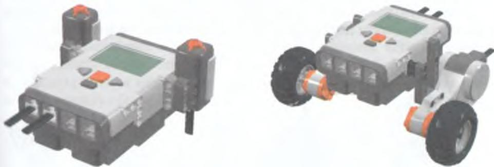
Рис. 8.88. Управление движением тележки с помощью датчиков касания.
