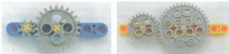
Рис. 2.7. Передача с понижением скорости: слева  $i=3:1$ , справа  $i=5:3$  [3].
