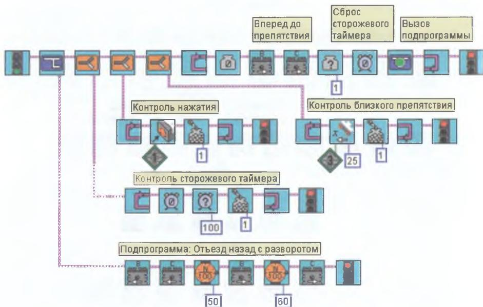
Рис. 8.56. Алгоритм путешествия по комнате со сторожевым таймером.
