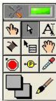
На текущем этапе нам важна только одна кнопка этой панели, а именно Автоматический выбор инструмента (Automatic tool selection), которая позволяет автоматически подбирать инструмент под то действие которое мы хотим совершить. Если эта кнопка не нажата то необходимо ее нажать, тем самым выбрав автоматический подбор инструментов.
